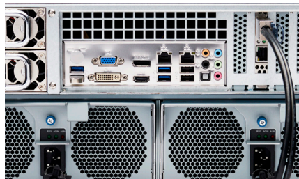
ІО PANEL з 4 портами дисплея- двома портами - Audio IN/OUT - SAS Expander
