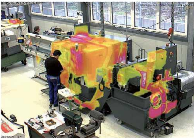
У тепловізійних камерах з двома об'єктивами MOBOTIX реалізована технологія «температурного накладення», що дозволяє ідентифікувати «гарячі точки» на видимому зображенні і уникнути збитку.
