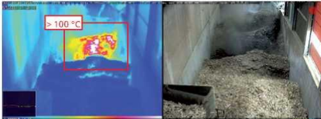
Теплова радіометрія (ТР): автоматичне оповіщення при виході температури за рамки заданого діапазону.
